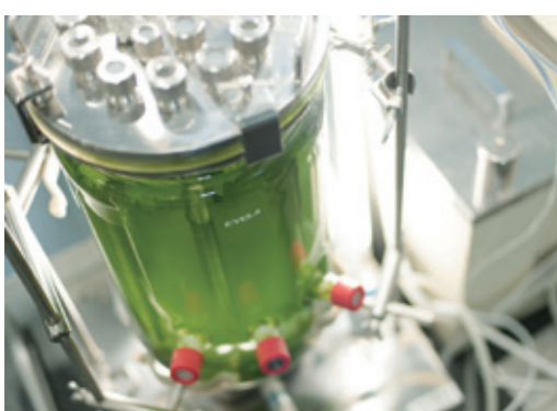
ミドリムシの培養液が入った培養槽「バイオアクター」
